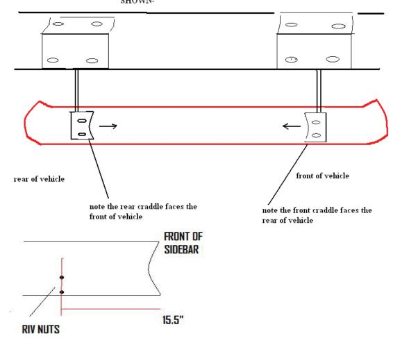
NOTE: TO ESTABLISH FRONT OF THE SIDEBAR- AT THE BOTTOM OF THE TUBE YOU WILL HAVE THE RIV NUTS 15.5" FROM THE END. THE TUBE WILL FACE INWARD.
