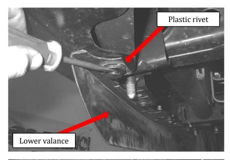
**STEP-1** REMOVE THE PLASTIC RIVETS, AND BUMPER VALANCE FROM THE BOTTOM OF THE BUMPER
