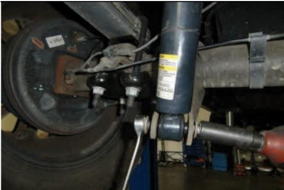
Remove lower shock bolt.
