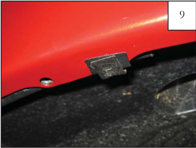
Install Clip (CL1-0022) over Tab (MT1-0014).
